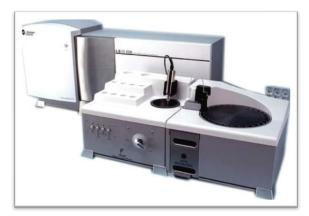
Fig. 7.3 Particle size analyser
